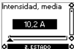
En el caso de conexión monofásica la pantalla muestra la intensidad del hilo neutro.
