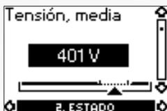
En el caso de conexión monofásica, la pantalla muestra la tensión de red  $U_{L-N}$ .
