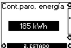
Contador para medir el consumo de energía. Puede ponerse a cero. Ver sección 9.4.12.
